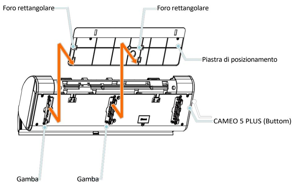
**3** Posizionare l'alimentatore automatico di fogli A3 PLUS sui pioli destro e sinistro della base di posizionamento.
