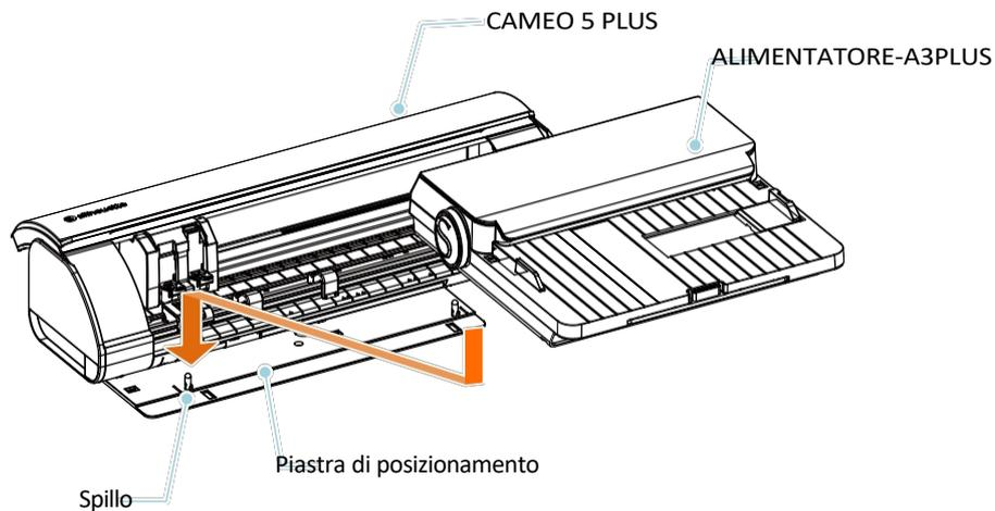
**4** Per collegare la macchina a CAMEO 5 PLUS, utilizzate il cavo di alimentazione incluso nell'Alimentatore automatico di fogli A3 Plus. Inserite il cavo CA fornito con CAMEO 5 PLUS nella base del cavo di alimentazione e poi nella presa di corrente.
