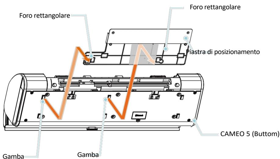
**2** Posizionare l'alimentatore automatico di fogli sui pioli destro e sinistro della base di posizionamento. L'alimentatore automatico di fogli deve essere stabile e ben saldo in posizione. Se l'alimentatore automatico di fogli si sposta in qualsiasi punto, potrebbe essere necessario riposizionarlo sulla base di posizionamento.
